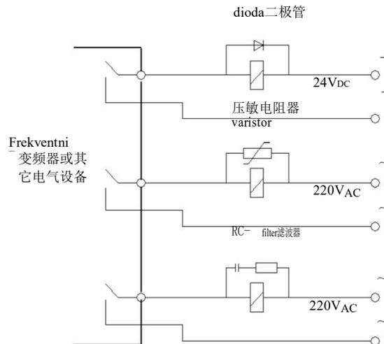
Sl.4-3 Zahtevi za instalaciju elektromagn.on-off uređaja
