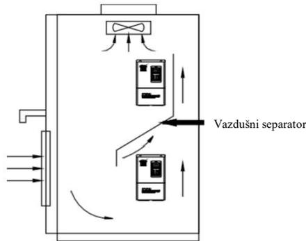
SI.3-2 Instalacija više od jednog frekv.regulatora
