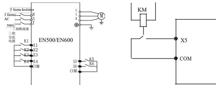
Sl. 7-14 El.šema rada sa višestep.brzinom Sl. 7-15 Implementacija signala na ulaz.terminal
