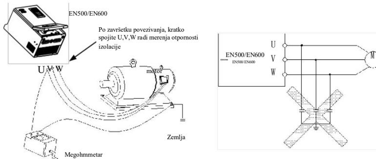
**Sl.1-1 Provera izolacije motora**    **Sl.1-2 Nije dopušteno povezivanje kondenzatora sa izlazima frekventnog regulatora**
