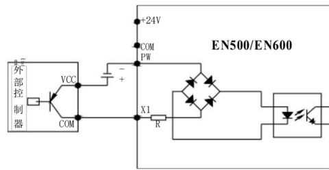
SI.3-17 Povezivanje korišćenjem ekster.izvora napajanja i signala PNP logike
