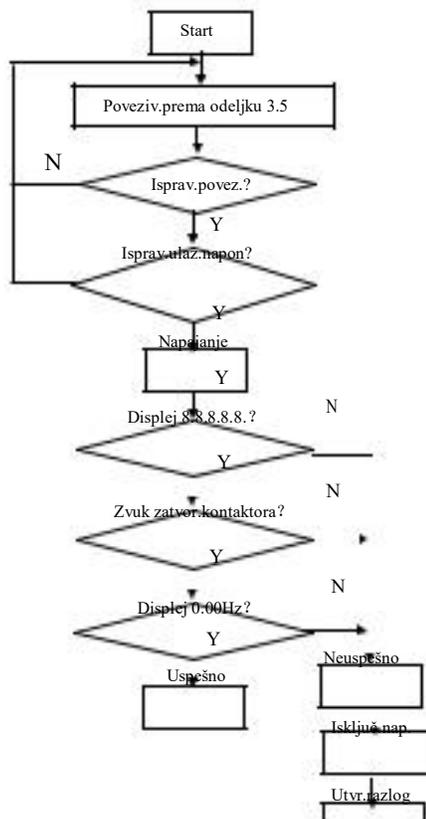
SI.5-12 Dijagram toka prvog priključenja napajanja frekv.regulatora
