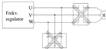
SI.3-6 Zabrana priključivanja kondenzatora ili kontaktora
