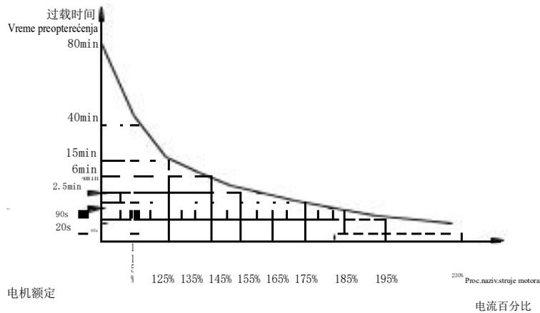
**Fig.7-46 Zaštita elektronskim termorelejem**
