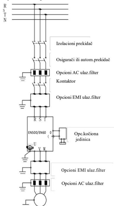
SI.3-8 Povezivanje frekv.regulatora i priključnih komponenti
